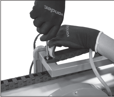
Fig. 4 – Estera porta cables
