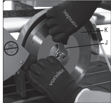
Fig. 14 – Instalação do disco
