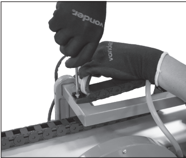
Fig. 4 – Esteira porta cabos
